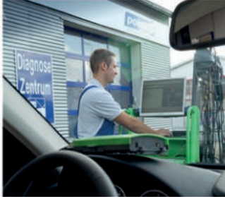
Fehlerdiagnose Steuergeräteauslese Kundendienstrückstellung mit modernem Motortester
